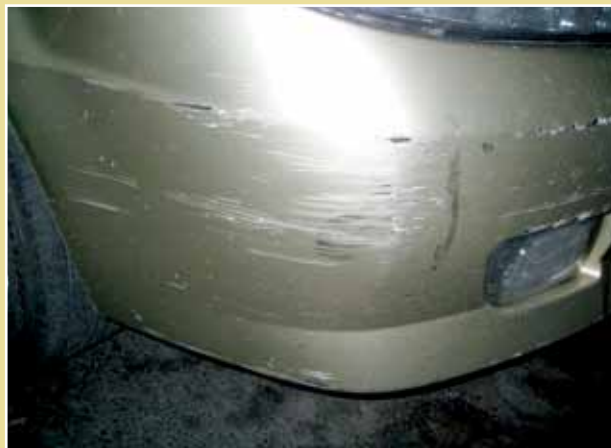
▲圖4、閃光燈照射角度與車體物面垂直形成顯著的光斑現象。
